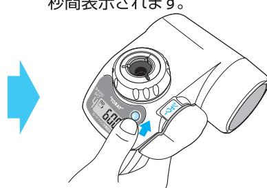
**!** カートリッジの取付け、交換の時は必ずリセットボタンを押してください。
