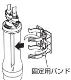
2 カートリッジ接続部のツマミを上げたまま、カートリッジ接続部をしっかり押さえ、カートリッジを左方向に回します。
