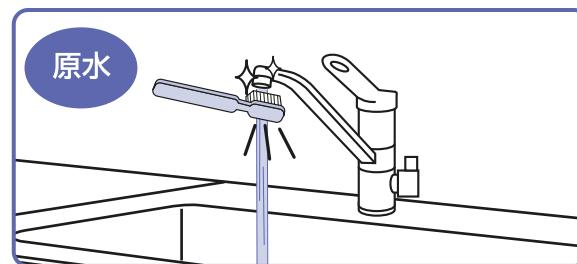
浄水口は、消毒(殺菌)用の塩素が取除かれた水の出口です。汚れたハブラシ・布巾・スポンジ等で洗うと浄水口の内側に一般細菌が付着・繁殖することがあります。
