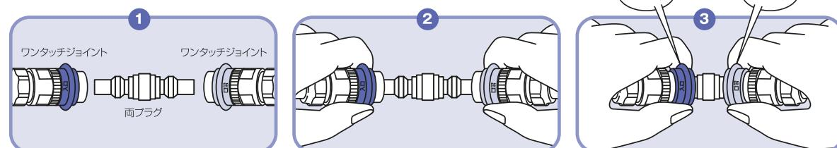
**注意** ホースを付けたり、外す時にホース内に残った水が流れ出しますので、必ず水を受ける容器(ボール、洗面器など)を置き、その上で両プラグの取外し、取付けを行ってください。
