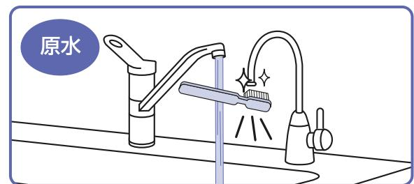
注:浄水口は水道水の原水を使用して清潔なハブラシなどで汚れを落とし十分にすすいでください。
