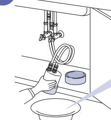
ホースを外す時にホース内に残った水が流れ出でてきますので、水を受ける容器(ボール、洗面器など)を必ずカートリッジの下に置いてください。
