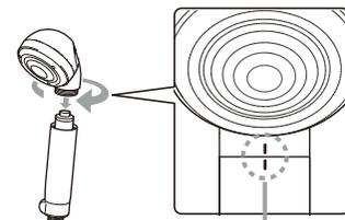
強く締め過ぎると外れなくなる場合があります。また、内部のカートリッジが破損し、使用できない恐れがあります。締める際はこの印で合わせてください。
