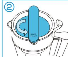
栓とロートが閉まっている状態から反時計回りに回します。ロートは栓と一緒に回ります。
