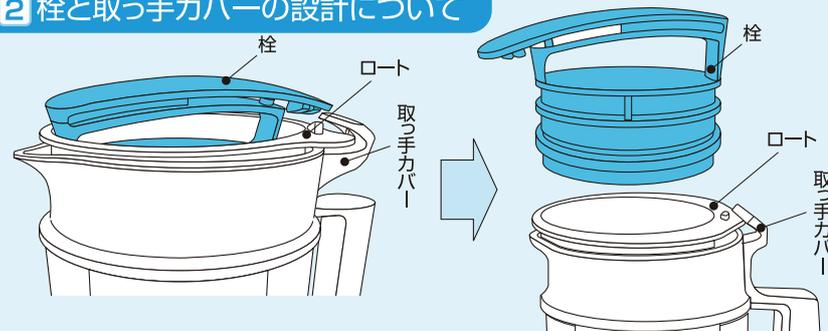
取っ手カバーは栓とロートを離す役割をします。栓を回す際は必ず取っ手カバーを取り付けたままにしてください。(使い方は8ページを参照ください)
