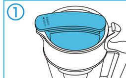
栓とロートが栓の「CLOSE ▶」とロートの「□」印が本体容器の「□」印に重なっているか確認してください。
