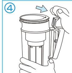
取っ手カバーの上部を引いて外します。外しにくいときは横にずらしながら引くと取り外せます。
