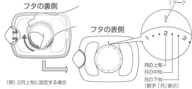
フタの裏側からダイヤルを時計回りに(表側から見て反時計回りに)回して、表側の「マーク」に交換時期を合わせます。交換時期は、月の上旬・中旬・下旬で設定します。
