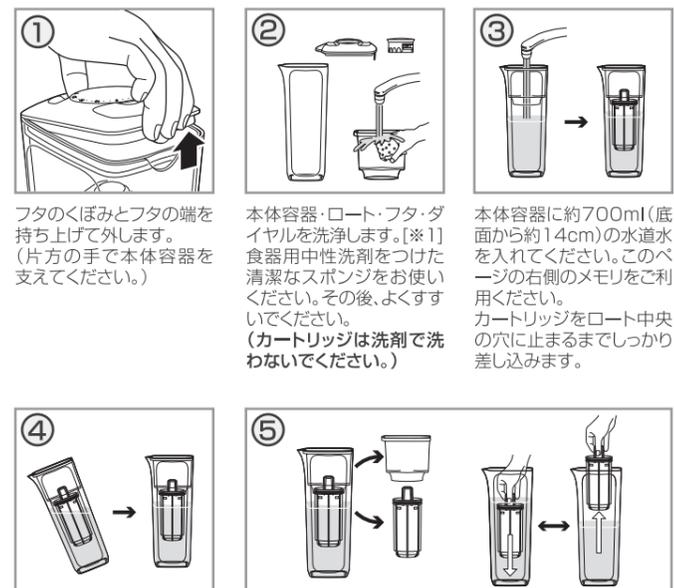
水がこぼれない程度に本体を一度傾けてください。(カートリッジ内の空気を抜くため。)その後、そのままカートリッジを水に20分間浸します。
