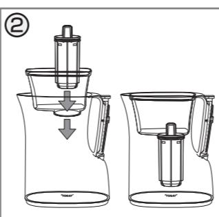
ロートを本体容器にセットします。カートリッジをロート中央の穴に止まるまで差し込みます。
