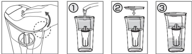
フタの後方(図の丸印部分)に親指をそえて、矢印の方向に引き上げるように開けます。(片方の手で本体容器を支えてください。)
