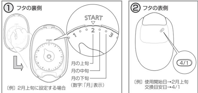
フタの裏側についているカートリッジ交換目安ダイヤルの「現在の日付に近いところ(月の上旬・中旬・下旬)をSTART▼に合わせます。(図は2月上旬に設定する場合の図です。)
