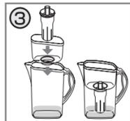
ロートを本体容器にセットします。カートリッジをロート中央の穴に止まるところまで差し込みます。そのままカートリッジを水道水に約10分間浸します。
