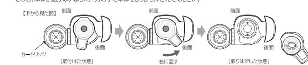
(取付けかた)右の図のように、吐水口キャップを本体前面左のママーグに合せて本体にはめ込み、「取りはずしかた」と逆の手順で取付けてください。吐水口キャップは上記の「取付けかた」の位置で止まるまで回してください。
