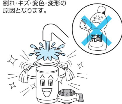
2. 浄水口は水道水(原水)を流しながら清潔なハブラシなどで汚れを落とし十分にすすいだあと、清潔な布で水気をふきとってください。
