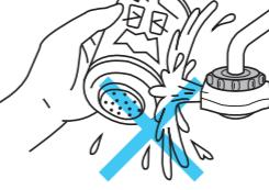
破損や水もれの原因となり、また、カートリッジ接続部から水が飛び出し周囲に水がかかります。
