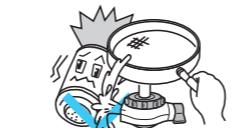
カートリッジがはずされカートリッジ接続部から水が飛び出し周囲に水がかかります。また、割れ・キズ・変色・変形の原因となります。
