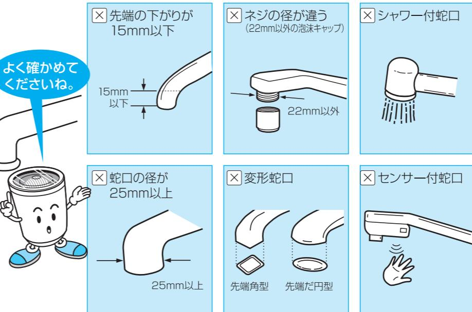
蛇口の先端にプラスチックの断熱キャップがついている場合、水栓の種類や状態によっては、取付け部より水もれしたり断熱キャップが破損したり取付けできないことがあります。取付け前に水栓のメーカー・品番をご確認の上、トレピーノ・サービスセンターにご相談ください。(フリーダイヤル 0120-32-4192)
