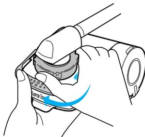
❗ 工具などにより取付けナットを締め
