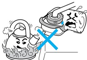
熱によって変色・変形したり破損する恐れがあります。
