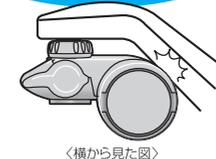
角度が急で、浄水器の後部が水栓にぶつかる場合は、右図のように切り替えレバーが手前にくるように取付けてください。
