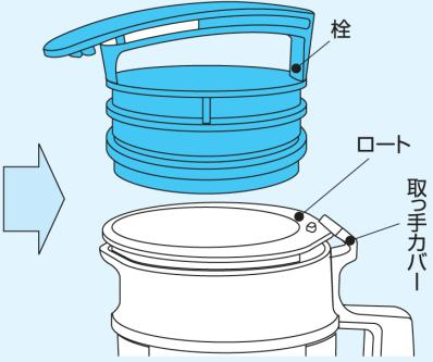
取手カバーは栓とロートを離す役割をします。栓を回す際は必ず取手カバーを 取り付けたままにしてください。(使い方は7ページを参照ください)
