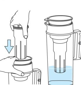
カートリッジをロート中央の穴に止まるところまで差し込みます。そのままカートリッジを水道水に約10分間浸します。
