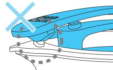
栓を閉める時は、栓の凸部がロートの 凸部の上を越えるまで時計回りに閉 めてください。
